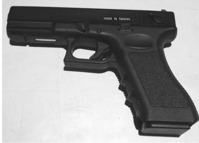
Ce pistolet est une copie du Glock 18, produit par l'entreprise autrichienne Glock. Son sélecteur permet de choisir entre un tir semi-automatique ou automatique à une cadence de plus de 1 100 coups/minute pour ce dernier mode. Cela fait de lui l'un des plus petits pistolets mitrailleurs existant.
